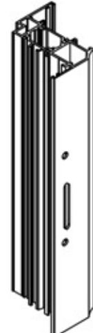
Tek Eksen Sol Açılım Kol Yeri İşlemi Single the axis Opening Left Arm Part operation
